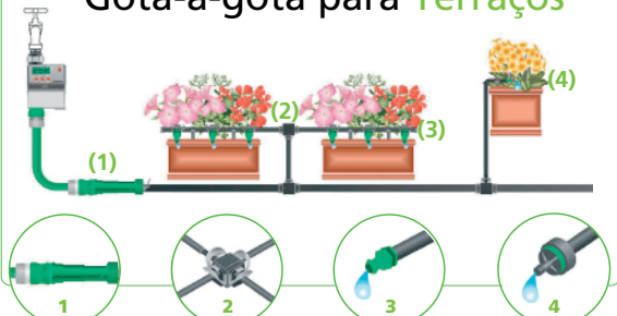
1 Redutor de Pressão 2 Ligação para 2,3 ou 4 Turbinas 3 Gotejador regulável para 2,4 ou 8 Litros/Hora 4 Gotejador autocompensante para caudal de água constante
